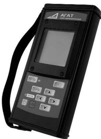
АГАТ-М – это двухканальный анализатор параметров вибрации, а так же лучший в своем классе прибор для проведения 2-х плоскостной динамической балансировки вращающегося оборудования в собственных опорах.
