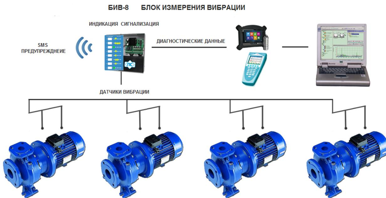
**Рис.3.** Структурная схема “САДКО-БИВ” Модификация №1.
